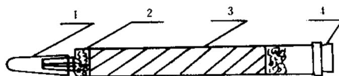
图 1 装填草酸玻璃微珠的采样管
